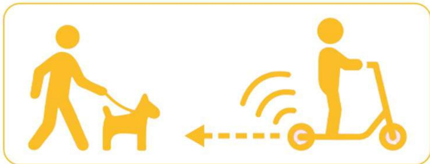
Движение задним ходом у таких ЭСИМ – не быстрее 6 км/ч. При движении задом должен включаться звуковой сигнал
